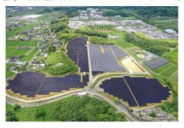
当プロジェクトは、遊休地であった土地を取得し、発電所用地として利用することで地域貢献に資する事業となります。当発電所はLS 広島三原に次ぐ約1年2ヶ月ぶりの自社開発発電事業であり、3施設合計で6,477.74kWの発電規模となります。これにより、当社の保有する太陽光発電所は合計51施設、稼働済発電所の合計発電量は約131MW(※2020年7月時点、売却分含む)となりました。
